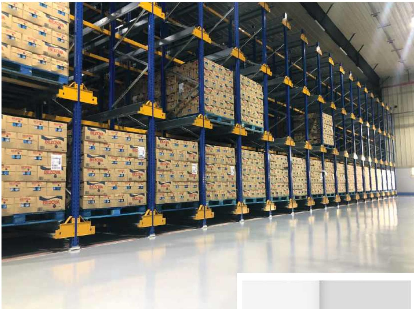
Sistema por compactación mediante carros autónomos que llevan a cabo los movimientos de pallets en el interior de las estanterías, sin necesidad de que las carretillas elevadoras entren en las calles de almacenaje.
