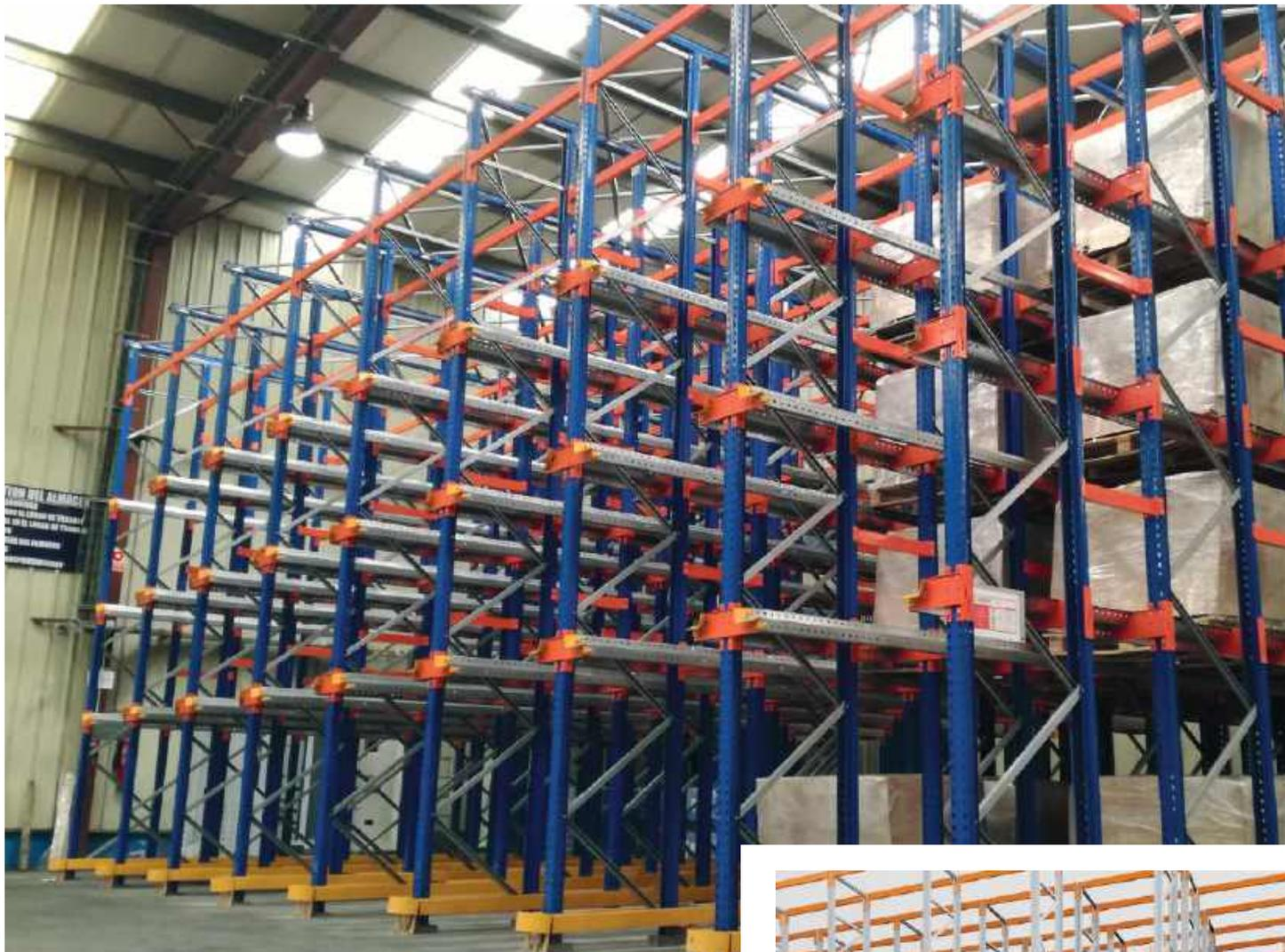
Sistema por acumulación compuesto por un conjunto de estanterías que forman calles interiores de carga con carriles de apoyo para los pallets. Las carretillas entran en las calles con la carga elevada.
